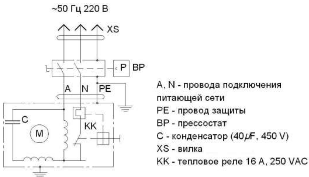
Рисунок А.2 - Схема электрическая принципиальная компрессоров СБ4/С-50.Ј2047В, СБ4/С-100.Ј2047В, СБ4/С-50.Ј2047ВВ, СБ4/С-100.Ј2047ВВ
